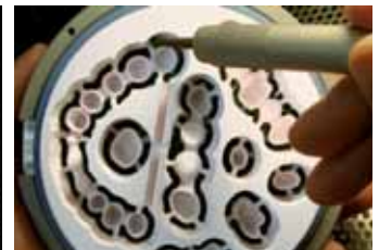
Sablage des tiges de maintien des éléments prothétiques (fraisés).
