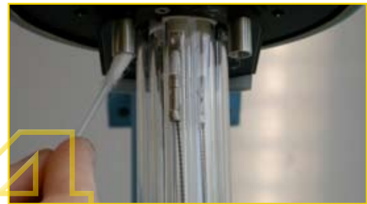
4 Anodensteckplätze und Referenzkathodensteckplatz säubern (Stauansätze!). Clean anode slot and Reference cathode slot (waterlogging!).
