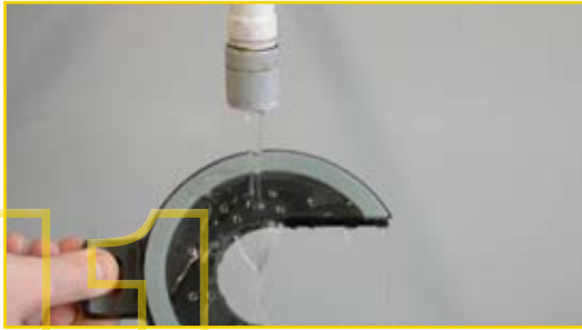
1 Kathodenblock unter fließendem Wasser abspülen,... Rinse cathode block under tap water,...
