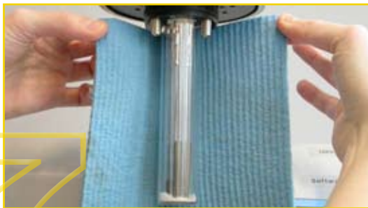
7 Ablagerungen am Glaskolben (zirkulär),... Sedimentation on the flask (circular),...
