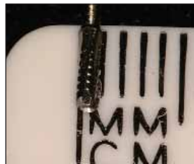
Midwest 1558-Bohrer mit einem Durchmesser von 1,0 mm
