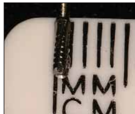
Fresa Midwest 1558 con diametro di 1,0 mm
